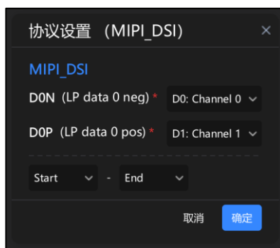
图 24.15.3.2 逻辑分析仪协议设置
